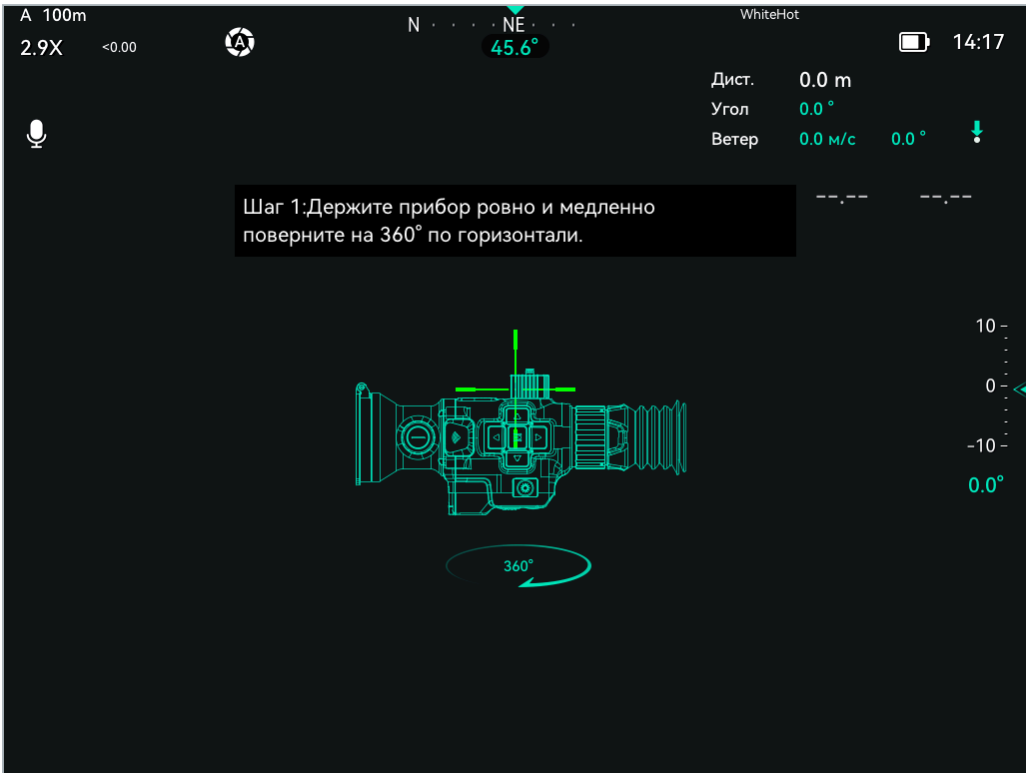
Калибровка компаса, первый шаг: поворот на 360° по горизонтали.
